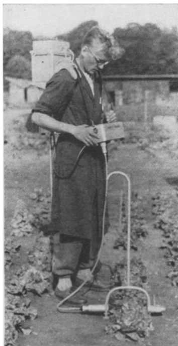
Abb. 6. Transportables Impulszählgerät zum Anschluß von Meßbügeln zur Bestimmung der Pflanzenmasse bzw. der Dichte von Einzelpflanzen auf Grund der Schwächung von radioaktiven Strahlen.
